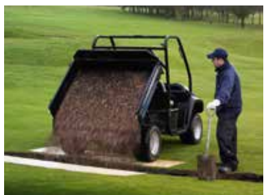
Pritsche elektrohydraulisch kippbar (optional).
