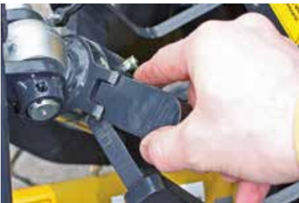
Stufenlose Neigungsverstellung: Im Oberlenker integrierte, stufenlose Neigungsverstellung für Frontanbaugeräte (werkzeuglos).
