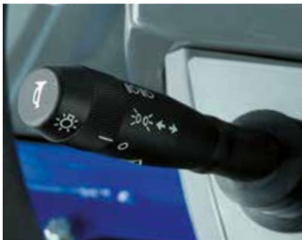
Ergonomisch angebrachter Multifunktions-schalter mit Beleuchtungssteuerung.
