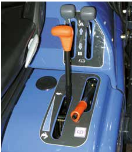
Der SFH 240 ist serienmäßig mit einem Tempomat zur stufenlosen Geschwindigkeitsfixierung und dem patentierten ISEKI-Leichtfahrsystem ausgestattet.
