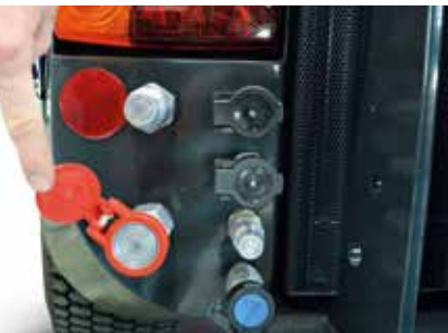
Die Heckhydraulikanschlüsse sind gut erreichbar angebracht.
