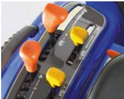
Durchdachte Bedienung: gelb = Zapfwelle, orange = Motor/Fahrantrieb. Äußerst leichtgängiger und präziser Hebelmechanismus.
