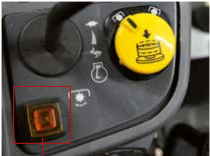
Separater Softanlaufschalter der Zapfwelle – bewährt aus den TG 5000er Modellen und einmalig in dieser Klasse.
