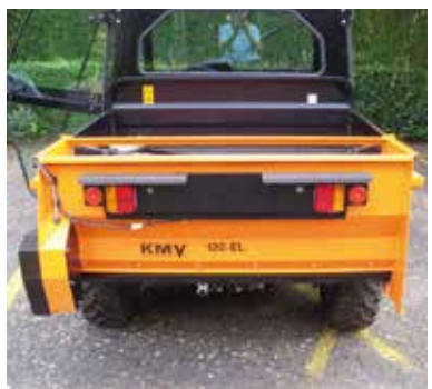
Anbaukastenstreuer mit Nachladefunktion über hydraulische Kipp-Pritsche.
