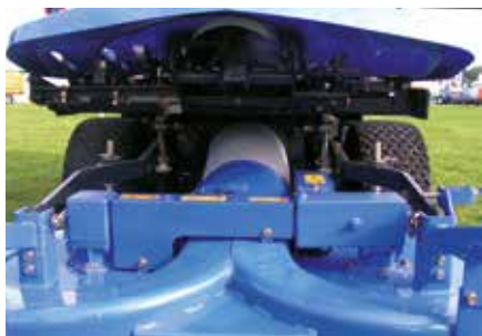
Kurzer Saugweg vom Mähwerk zur Absaugturbine.
