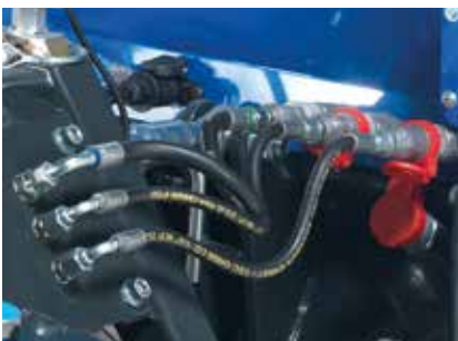
Flachdichtende und absolut tropfarme Hydraulikstecker.
