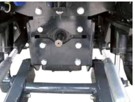
Serienmäßig mit mechanischer Getriebepfahle vorn ausgestattet. Durch die formschlüssige Kraftübertragung werden hohe Drehmomente erreicht.
