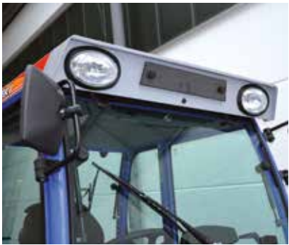
Im Dach integrierte Zusatzhauptscheinwerfer sorgen für eine optimale Ausleuchtung des Arbeitsbereiches - besonders im Wintereinsatz. Der Pollenfilter sorgt für saubere Luft im Kabineninneren.
