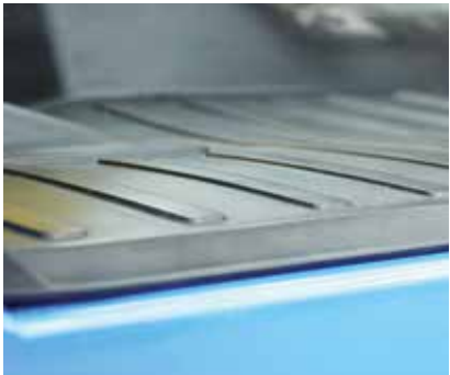
Die durchgehende Gummimatte dämmt den Kabineninnenraum gegen Lärm und Kälte und gewährleistet insbesondere im Wintereinsatz einen kontrollierten Wasserablauf (Reduzierung von Korrosion).
