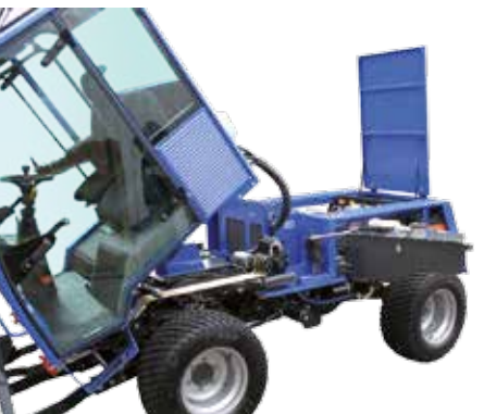
Optimaler Wartungszugang durch die praktische, hydraulische Kabinen-Kippfunktion.
