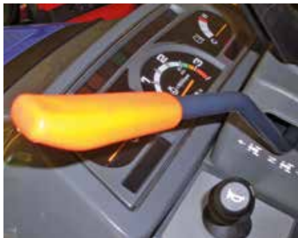
Die Wendeschaltung (Modell AL) ist ideal für schnelle Richtungswechsel im Arbeitseinsatz. Dabei beträgt die Rückwärtsgeschwindigkeit ca. 75% der Vorwärtsgeschwindigkeit. 8 Vor- und Rückwärtsgänge bieten in jeder Fahrsituation den optimalen Geschwindigkeitsbereich. Bei der Hydrostat-Version (AHL) wird diese Funktion durch die 2-Pedalsteuerung ersetzt und erfolgt stufenlos.
