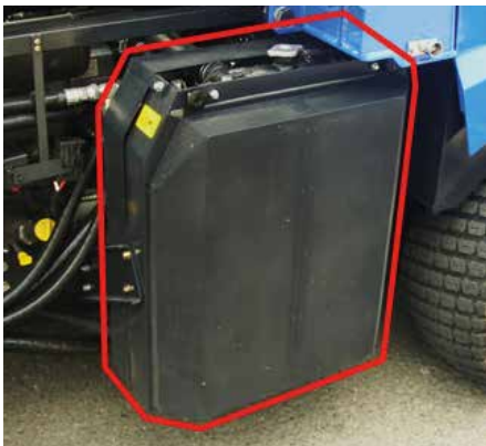
Kühler mit Umkehrlüfter garantiert Temperatur-Stabilität in jeder Situation
