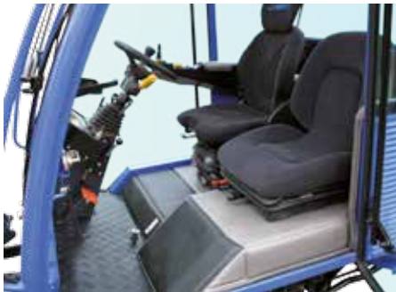
Der ICT 50 bietet viel Platz für Fahrer und Beifahrer. Die leistungsstarke Heizungsanlage ist in die Kabine integriert und wird auf Wunsch als kombiniertes Heiz-Klima-Gerät geliefert.
