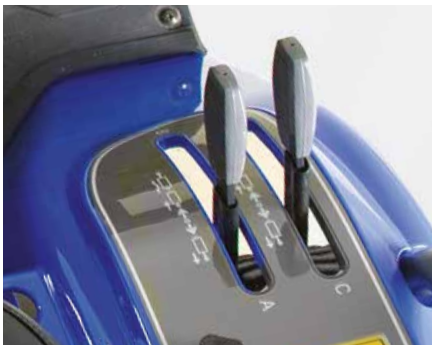
Modell AHL (Bügel) : 2 Hydraulikventile zur Anbaugeräte-Steuerung Modell AL (Bügel): serienmäßig 1 Steuergerät, zweites optional).
